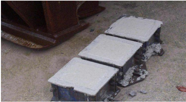
Fig.No:8.1 Casting of Cubes
