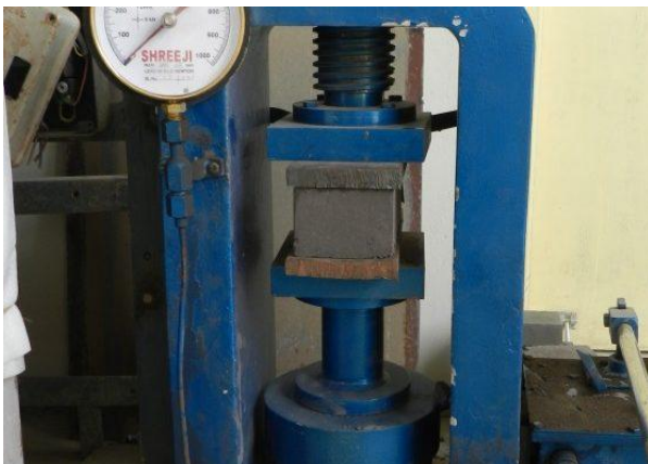
Fig.No:8.2 Testing of Cube Specimens
